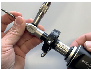
Fig. 9: Feste av et endoskopikamera til standardisert okulartrakt
