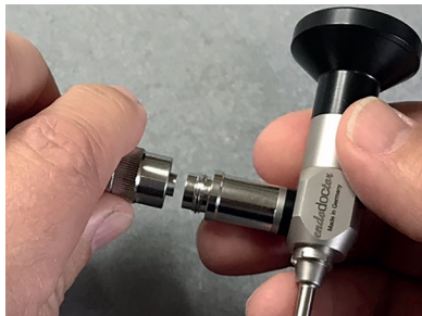
Рис. 5. Резьбовое соединение оптоволоконного кабеля (совместим с *Storz, *Olympus)
