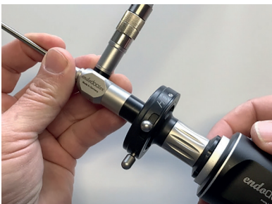
Obr. 9: Umístění endoskopické kamery na standardizovaný trychtýř okuláru
