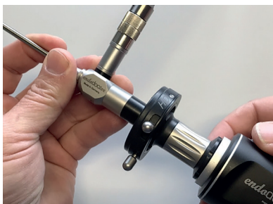
Fig. 9: Sätta på en endoskopikamera på det standardiserade okularet
