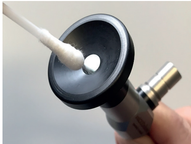
Fig. 4 : Nettoyage de la fenêtre proximale
