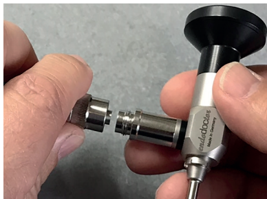
Fig. 5: Conectarea unui cablu de fibră optică cu filet (compatibil cu furnizorii *Storz, *Olympus)
