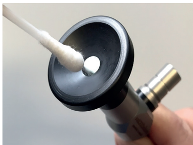
Fig. 4: Rengøring af det proksimale vindue
