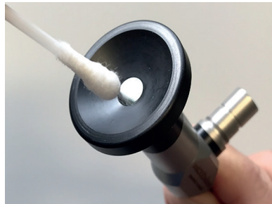
Fig. 4: Limpieza de la ventana proximal
