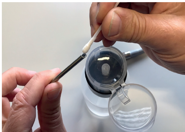
Obr. 2: Čištění distálního konce
