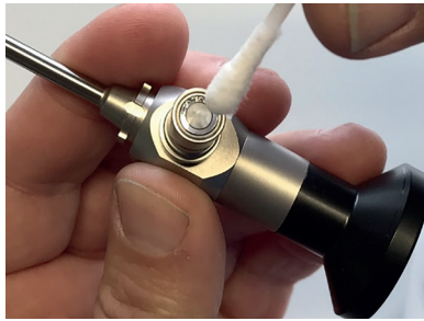
Abb.3: Reinigen des Lichtleiteransatzes
