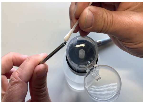
Fig. 2: Limpieza del extremo distal
