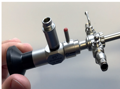
Рис. 8. Оба компонента можно плотно соединить поворотом блокирующего рычага по часовой стрелке. Соответственно, отсоединение выполняется поворотом блокирующего рычага против часовой стрелки.
