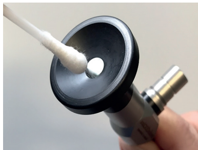
Fig. 4: Het proximale venster reinigen
