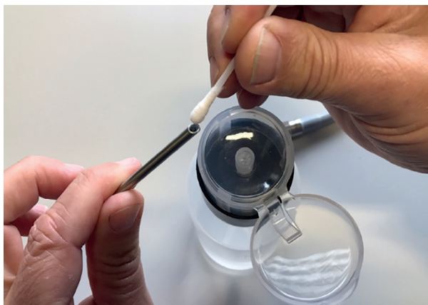
Fig. 2 : Nettoyage de l'extrémité distale
