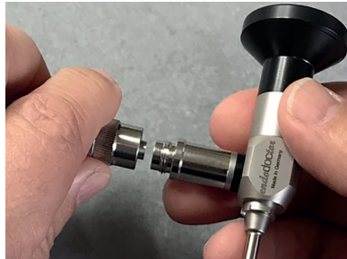
Sl. 5: Povezivanje optičkog kabla sa navojem (kompatibilno sa dobavljačima *Storz, *Olympus)
