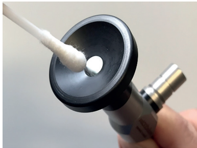
Abb.4: Reinigen des Proximalen Fensters
