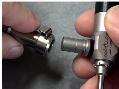
Sl. 6: Povezivanje optičkog kabla sa mehanizmom za fiksiranje (kompatibilno sa dobavljačem *Wolf). Uklonjena je prva čaura nastavka za optički kabl
