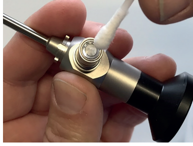
Şek. 3: Işık kılavuzu bağlantısının temizlenmesi
